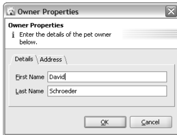
Figura 3.3: Un esempio di form composita tratto dall'applicazione PetClinic: si vede che la form è divisa in due sottoform tramite due tab
